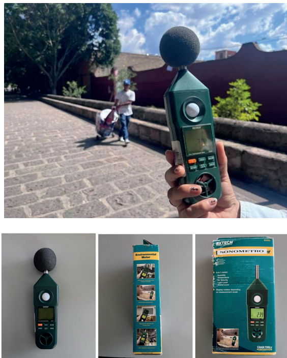
Figura 6. Imagen del sonómetro utilizado para mediciones en este estudio.
