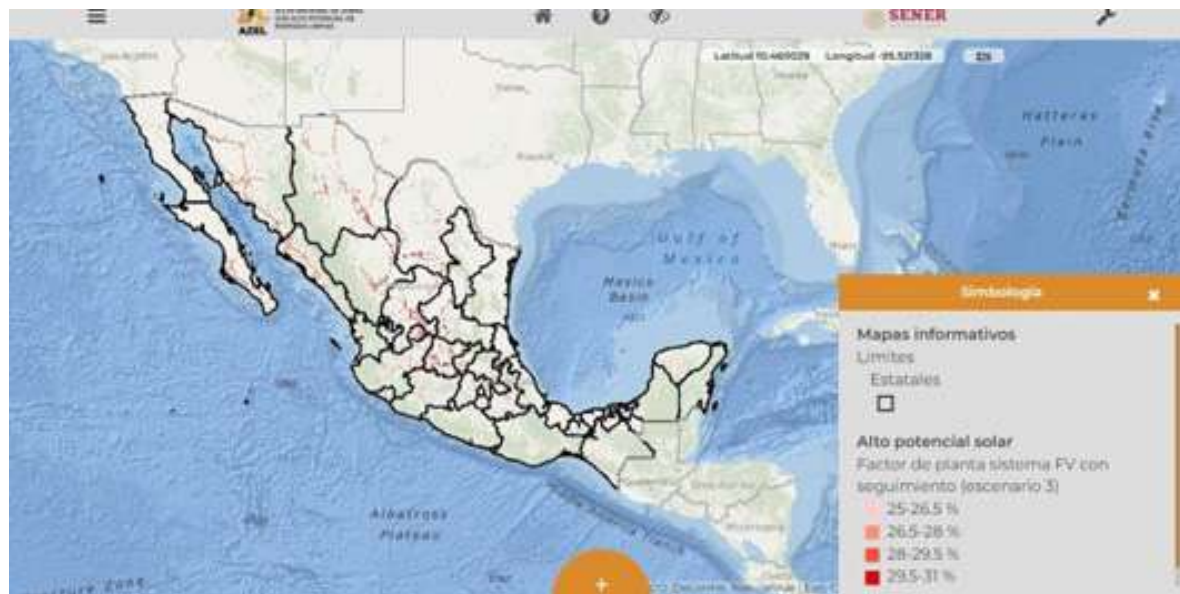
Imagen 13. Alto potencial solar, escenario 3, distancia media de 2 km a la RNT. Fuente: Sener (AZEL).
