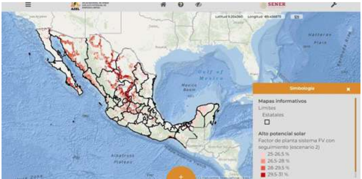
Imagen 15. Alto potencial solar, escenario 2, distancia media de 20 km a la RNT. Fuente: Sener (AZEL).
